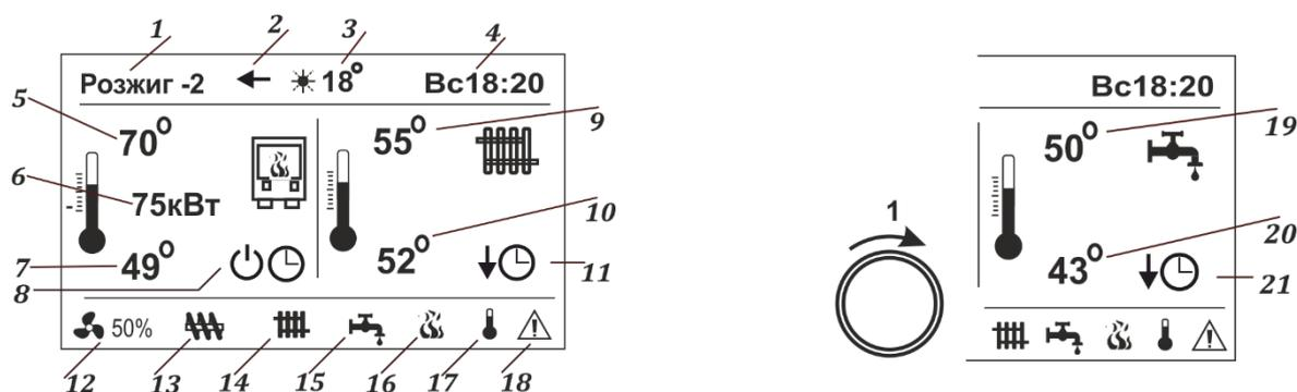
1. Режимы работы контроллера: ВЫКЛЮЧЕН, ТЕСТ ПЛАМЕНИ, РОЗЖИГ, НАГРЕВ, ТУШЕНИЕ, ОЖИДАНИЕ.
